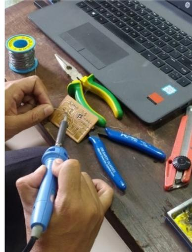
Gambar 7. Proses penyolderan komponen
