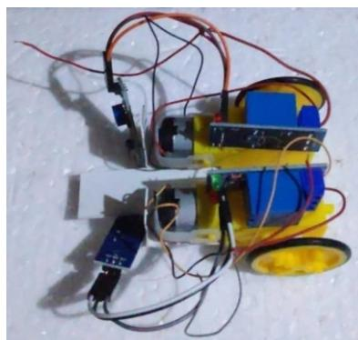
Gambar 6. Model Rangkaian Robot dengan Relay
